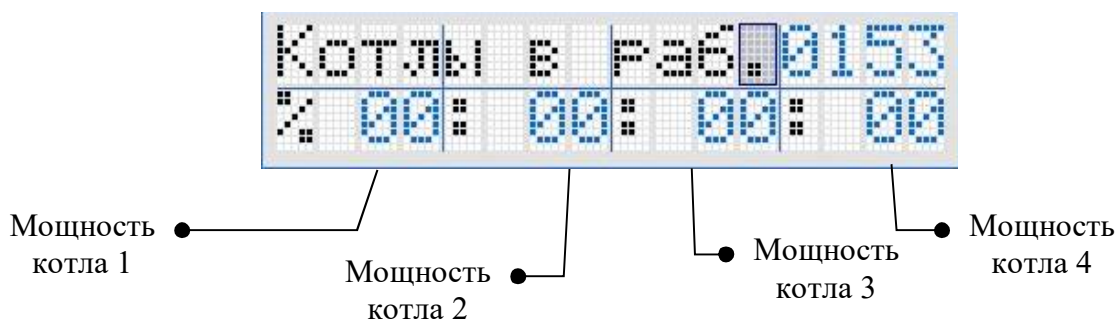
Рисунок 4. Индикация мощности горелок котлов.
