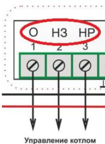
Контакты 1, 2 и 3 терmostата предназначены для подключения к котлу при управлении в релейном режиме. На котле это клеммы комнатного терmostата
