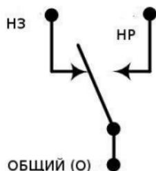
Для управления котлом терmostat ZONT имеет на 1, 2 и 3 контактах выходное реле. Контакты имеют обозначение "Общий", "НЗ" и "НР". К котлу надо подключить два из трех контактов.
