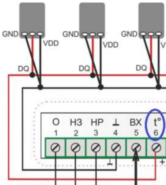
Подключаются к контактам термостата в шлейф. Одновременно может быть подключено до 10-ти шт., параллельно. Удаленность последнего датчика в шлейфе не должна быть более 100 м. Длинные ответвления от основного шлейфа не допустимы, т.к. могут привести к неработоспособности всего шлейфа.
