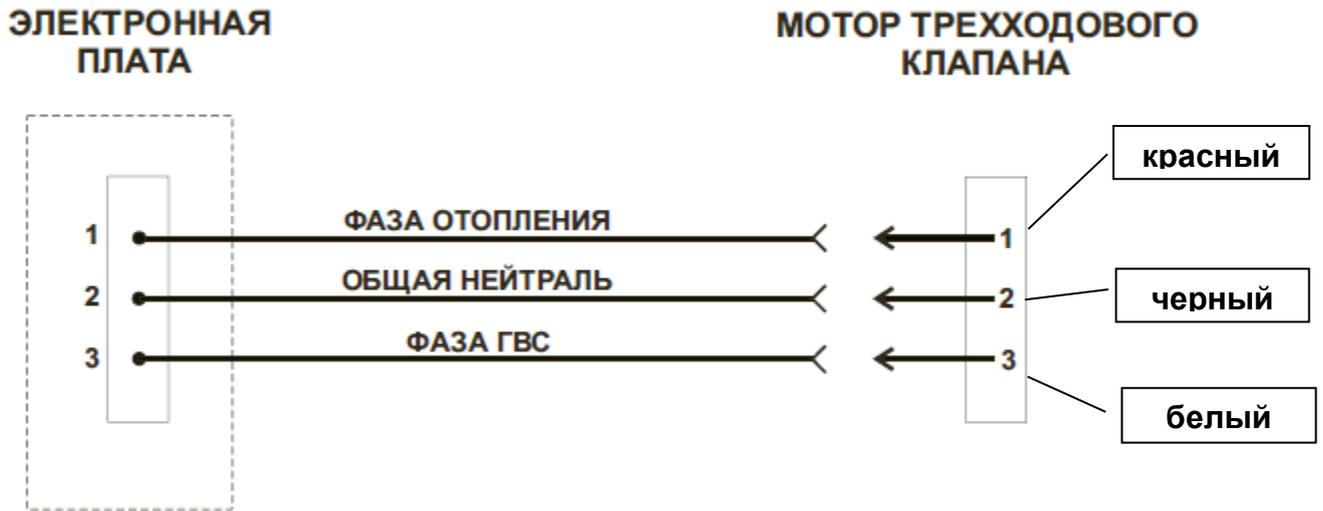
**11.6. Электрическая схема подключения мотора 3-х ходового клапана, для котлов с композитной гидрогруппой.**
