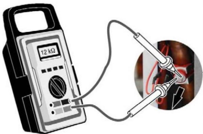
Датчик температуры контура ГВС погружной (NTC)
